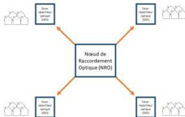
Schéma de raccordement du réseau THD
